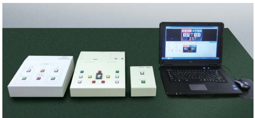
左から武道時間操作盤 / 競技操作盤 / 時間操作盤 / チーム名・得点入力装置
